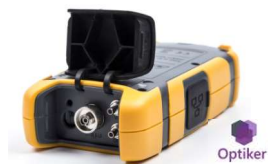
Conector de OTDR: SC /UPC
