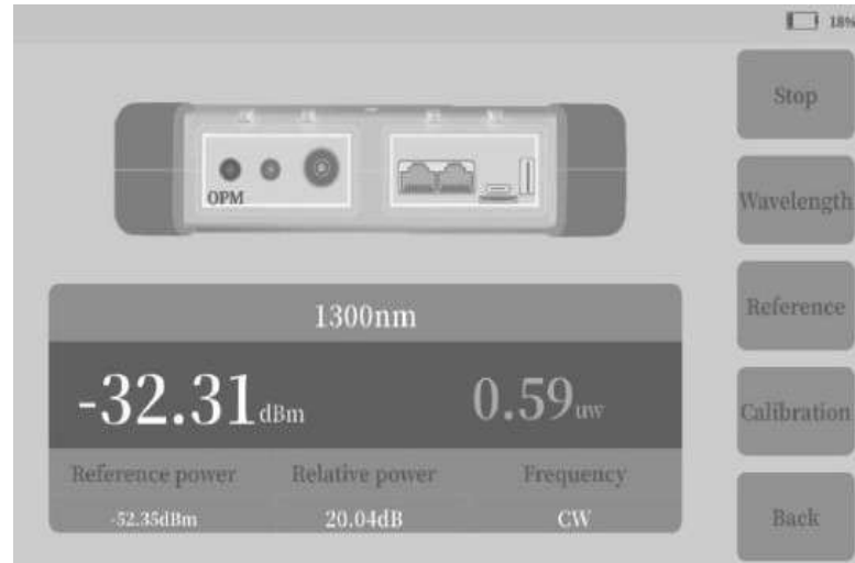
Modo de Medidor de Potencia
