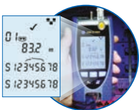
Mapeado con longitud
